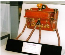
1888(明治21年) ガワーベル電話機 通信省工務局製
