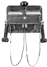
1890(明治23年) ガワーベル電話機 通信省工務局製 (明治21年のものより改良されている)
